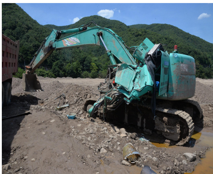
图6 涉事挖机被压后变形
