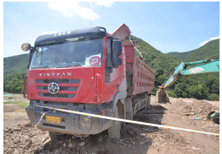
图5 涉事自卸车车厢顶部破损
